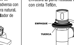
6. Pase el cuerpo del desague a través del agujero del desague y atórmelle el rebordo. Sosteniendo el cuerpo del desague con la abertura del pivote dirigida hacia la parte de atrás del lavabo. Ajuste la tuerca de montaje.
